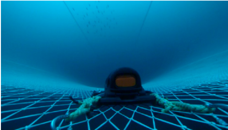
Figur 2. Simrad PX tråloye montert på underpanelet i en pelagisk trål under er CRISP tokt (til venstre) og TV80 programvare for visualisering av data fra redskapet (høyre). Ekkogrammer fra tråloyer vises på venstre side av TV80 skjermen, avstanden av tråldørene over havbunnen, styrbord dør rulling og dørspredding til høyre.
