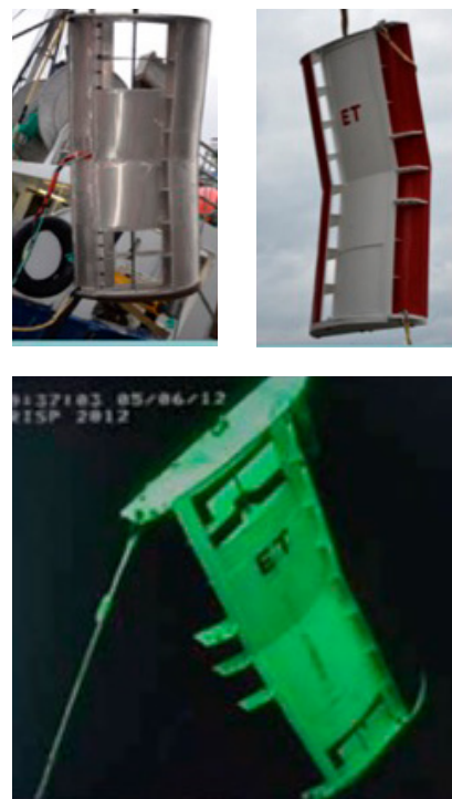
Figur 1. Styrbare pelagiske tråldører med luker over og under taue-brakettene som ble utviklet i crisp. Lukene kunne åpnes og lukkes av en motor som ble styrt via et akustisk kommunikasjonssystem.
