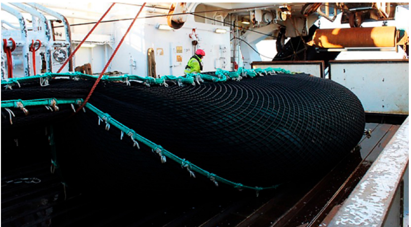
Testing av den nye 4-panels trålpøsen som er konstruert for å forbedre fangstkvaliteten. Egersund Group har designet den nye trålpøsen i samarbeid med CRISP sin forskere. Pøsen holdes lukket under tauing, men åpnes ved et bestemt dyp slik at fangsten får bedre plass under innhiving. (Foto: Nofima AS).
