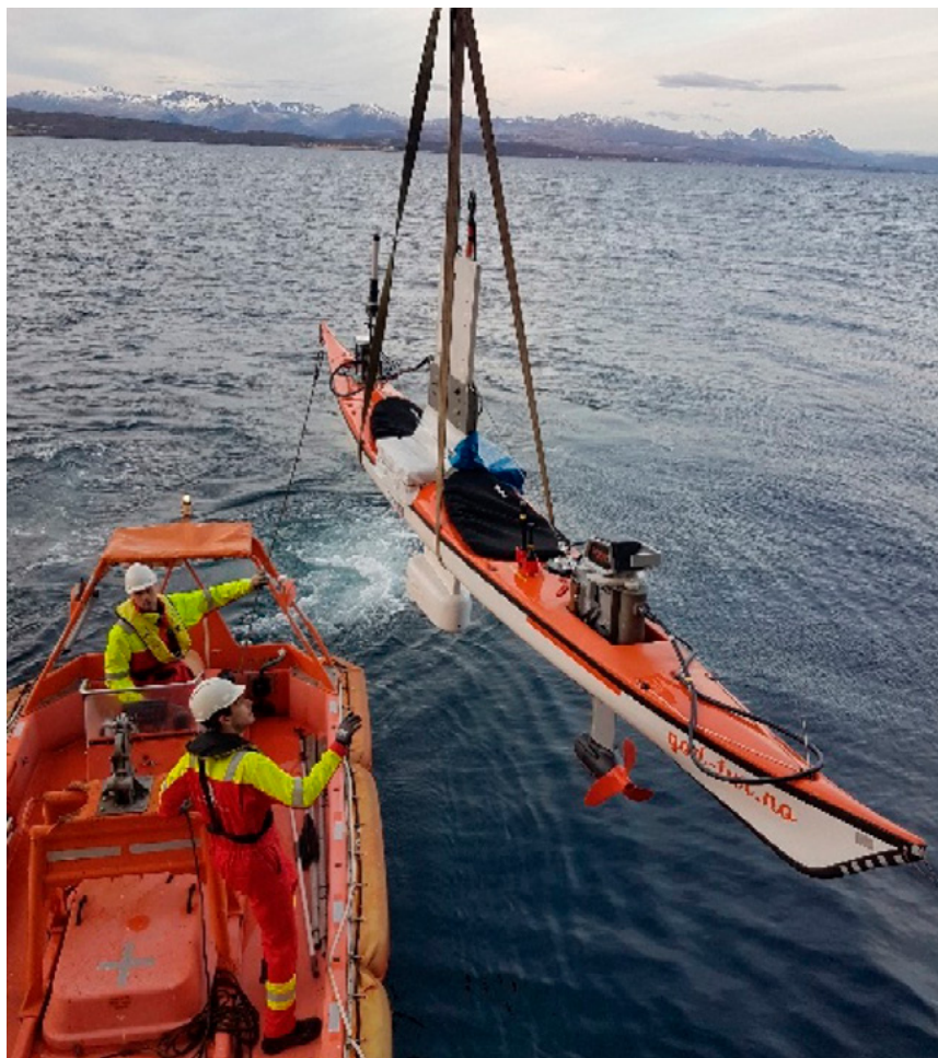
KayakDrone brukes til å måle sildelag i Kværnangen, 2018. Sildas reaksjon på til forskningsfartøyet ble studert og kvantifisert, og sammenlignet med fire andre målemetoder.
