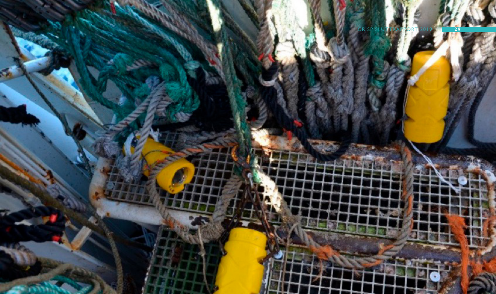
Figur 4. Tre posisjoneringstranspondere festet til blylina i en ringnot.
