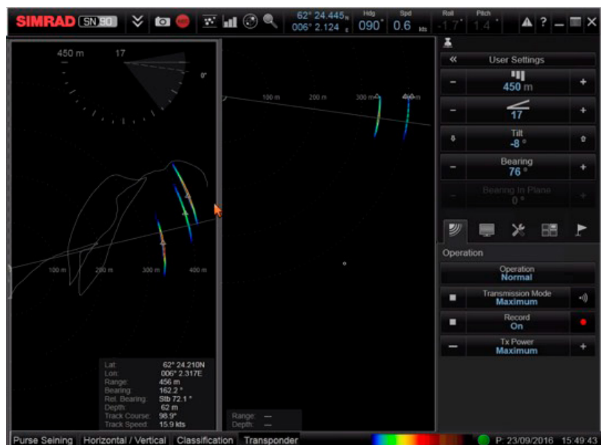
Figur 5. SN90 sonarskjerm som viser tre transpondere montert på bunnlina i nota ombord i FF "Brennholm". Horizontal seksjon (venstre panel) viser tre transpondere som fargede langstrakte registreringer mellom 300 og 400 m fra fartøyet. Fartøyets bevegelser mens nota settes vises som en hvit linje. I den vertikale delen (høyre panel) vises to av transponderne i en dybde på ca. 60 m.
